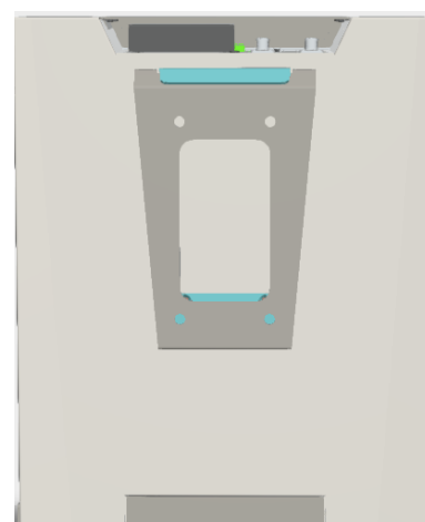
Vista Posteriore, staffa bloccata correttamente
