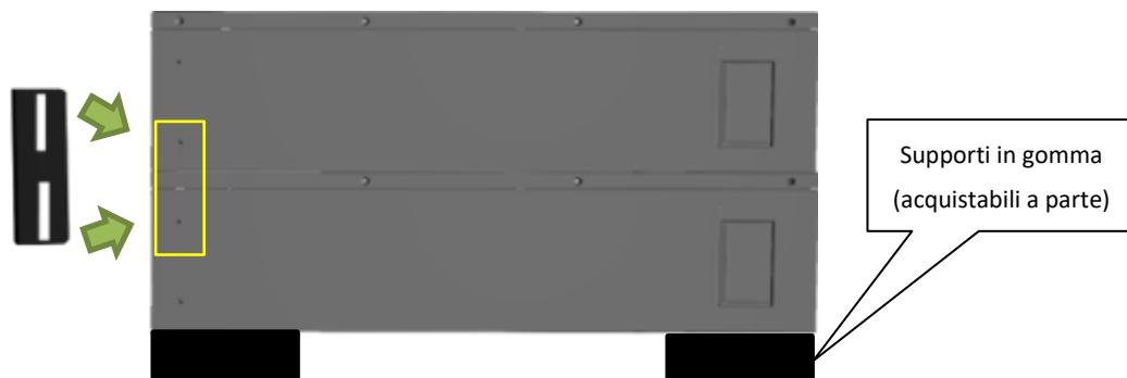
Passo 4: Una volta che ogni batteria è stata installata in posizione orizzontale, i piedini forniti con la batteria in configurazione standard possono essere rimossi e installati attraverso i moduli per vincolare da entrambi i lati i moduli tra loro.
