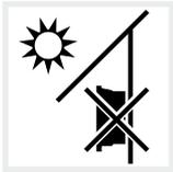
Speicherwechselrichter nicht im Außenbereich montieren.
