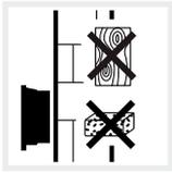
Speicherwechselrichter auf stabiler Montagefläche montieren, die das Gewicht sicher tragen kann. Gipskartonwände und Holzverschalungen sind nicht zulässig.
