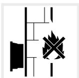
Ausreichenden Sicherheitsabstand zu brennbaren Materialien und explosionsgefährdeten Bereichen in der Umgebung sicherstellen.
