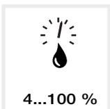
Die Luftfeuchtigkeit muss zwischen 4 % und 100 % (kondensierend) liegen.
